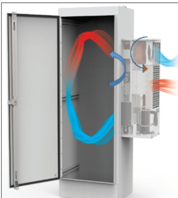
*Figura 7: Las unidades de refrigeración proporcionan un sistema de circuito cerrado. El aire circula dentro del contenedor y se acondiciona en un punto establecido fijo. El calor se rechaza a través de un circuito de aire acondicionado hacia el exterior.*
