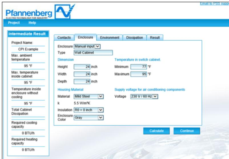
Figura 8: Captura de pantalla de Pfannenberg Software de dimensionamiento para seleccionar ventiladores de filtro y unidades de enfriamiento.
