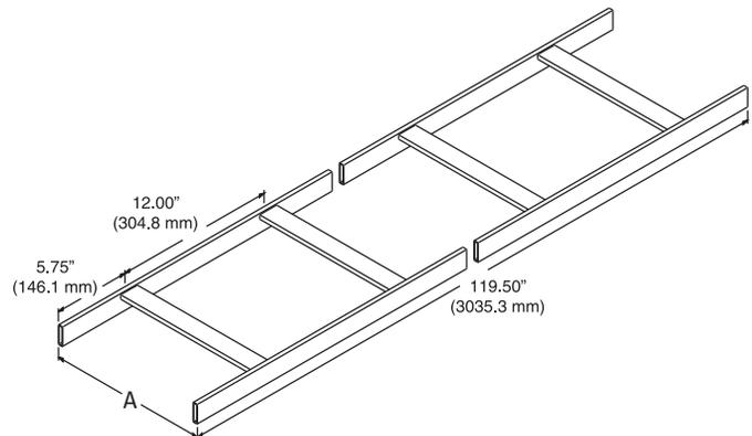
Nota: Se muestra en dos secciones para fines ilustrativos; el producto real tiene una sola pieza.
