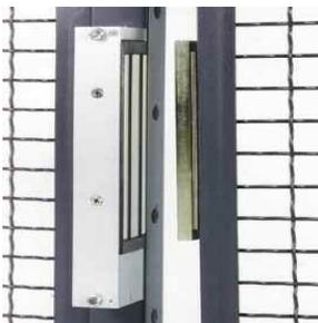
**Cerraduras Electrónicas** — La Cerradura Electrónica es una opción disponible. Los mecanismos de cerradura electrónica se accionan ante una señal de 12 o 24 voltios desde el Sistema de Acceso de Construcción (BAS). La Cerradura Electromagnética se usa en puertas corredizas, o se usa un Encastre Electrónico en puertas con tope.
